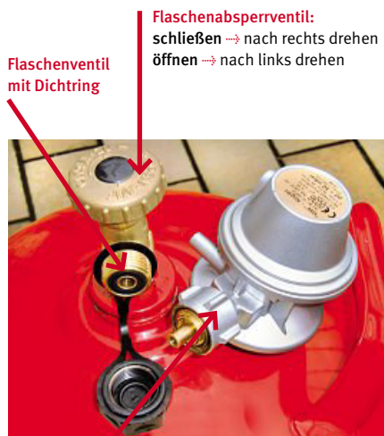
Bild 1: Kleinflasche mit Druckregelgerät
